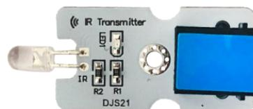
Ένας υπέρυθρος πομπός είναι απλώς μια Δίοδος Εκπομπής Φωτός, η οποία παράγει φως IR (αόρατο IR φως). Συνδυάζεται σε χρήση με τη μονάδα Δέκτη Υπέρουθρων DJS20 για τη δημιουργία κυκλωμάτων ελέγχου με IR και επικοινωνίες. Σε ένα υπέρυθρο τηλεχειριστήριο, για παράδειγμα, πιέζοντας ένα κουμπί, στέλνει ένα ηλεκτρικό σήμα στη λυχνία LED, η οποία μετατρέπει το σήμα σε δέσμη υπέρυθρου φωτός. Η συσκευή λήψης IR ανιχνεύει το φως με φωτοδίοδο και το μετατρέπει σε
