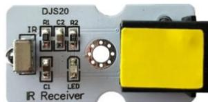
Ο δέκτης υπέρυθρων είναι ένα στοιχείο με λειτουργίες λήψης, διαμόρφωσης και αποδιαμόρφωσης σήματος και παράγει απευθείας ψηφιακό σήμα. Θα είναι επίσης εύκολο να φτιάξετε τον δικό σας ελεγκτή υπέρυθρων, χρησιμοποιώντας τον πομπό υπέρυθρων και να δημιουργήσετε έναν διακόπτη υπέρυθρων ακτίνων, ή να στείλετε σήματα από τον πομπό στο δέκτη.
